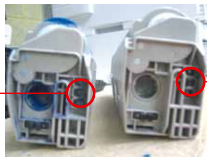
De centrale pin van Q Imaging op de verkeerde plaats. (Bron: OKI Printing Solutions)
